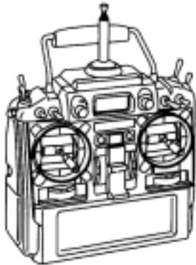
Computer Fernsteuerung mit 6-Kanälen (z.B. FC-16 oder FC18)
