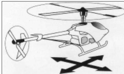
(2) Wenn der Hubschrauber auf dem Boden steht und der Rotor sich dreht, muß eine Funktionsprüfung durchgeführt werden, bevor das Modell abhebt. Bewegen Sie die Knüppel für Roll, Nick und Heck (Gier). Bewegt sich der Hubschrauber entsprechend Ihrer Steuerausschläge in die richtige Richtung?
