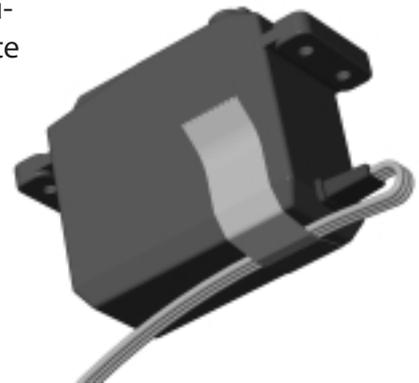
Vor der Montage des Roll- Servos, das Anschlußkabel wie abgebildet festkleben.
